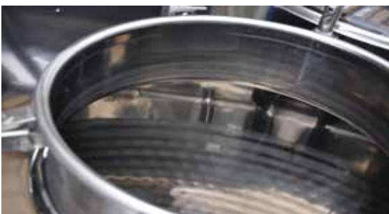
Saldatura interna, rasata e lucidata, del collo del chiusino
