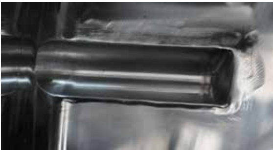
Saldatura interna lucida di scarico totale, a bocca di flauto
