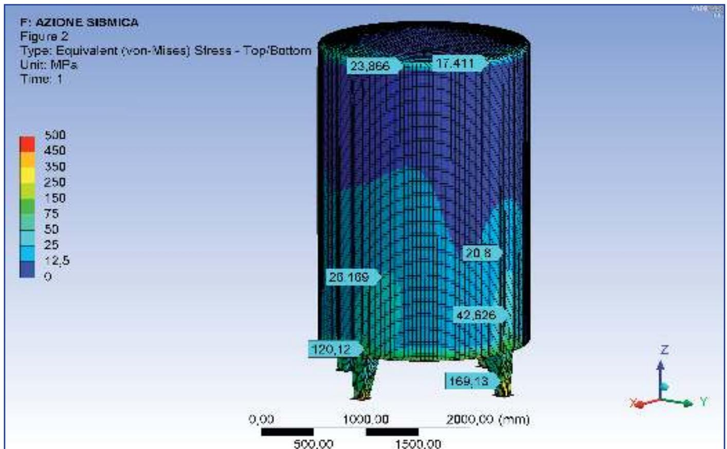
Tutti i piedi sono conici, scatolati, stagni e molto robusti, addirittura, sono sovradimensionati per il loro compito; sono applicati al fondo con una speciale struttura semi antisismica tramite anelli speciali e tiranti esclusivi Albrigi di rinforzi collaudati nel tempo.
